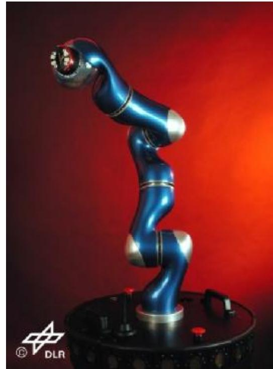
Рисунок 5 – Робот LWR, который может быть использован для выполнения массажа
