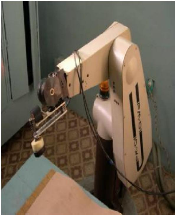
Рисунок 4 – Робот МГИУ для выполнения приёмов массажа и движения конечностей в суставах
