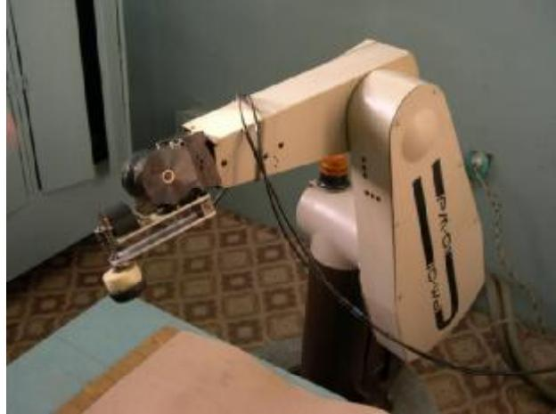
Рис. 2. Робот МГИУ для выполнения приёмов массажа
