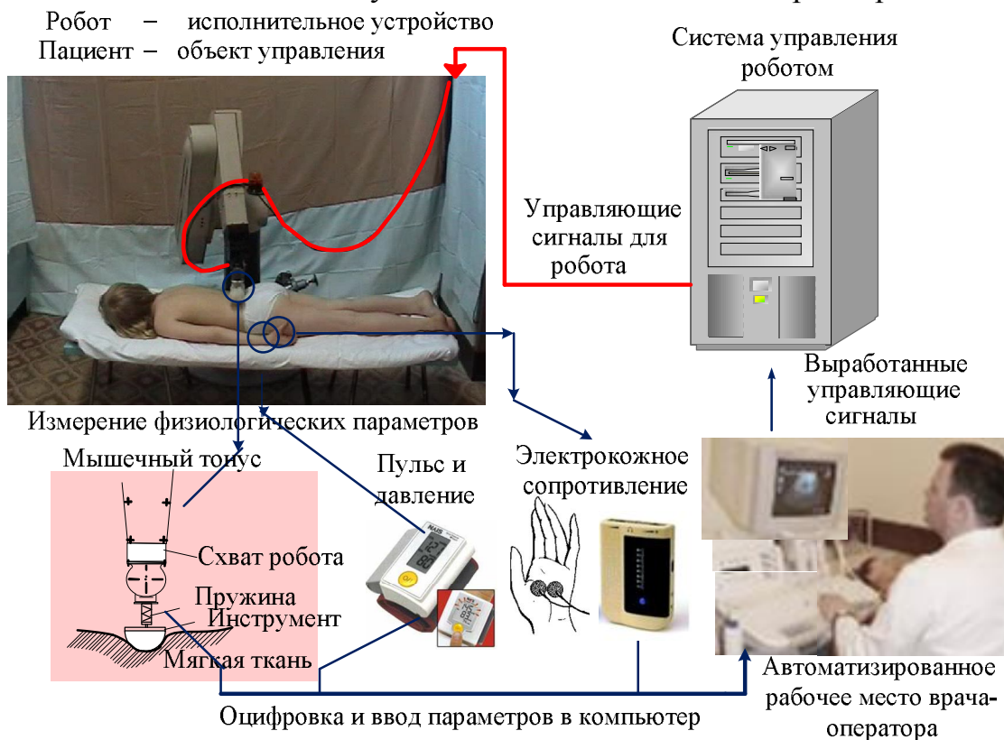
Рис. 15. Макет системы БТУ манипуляционным роботом для массажа
